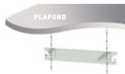
1 - FIXATION DE L'ÉTRIER AU PLAFOND
